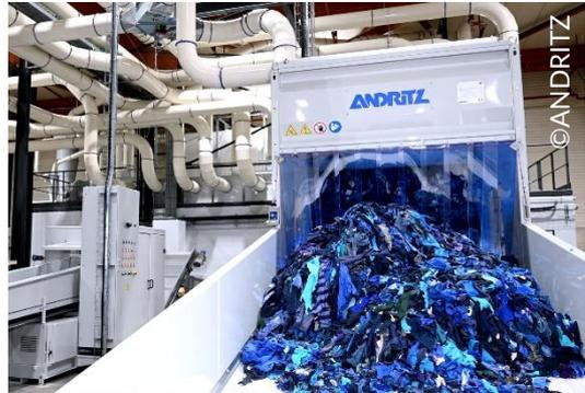
Le **broyage** consiste à réduire la taille des textiles en chiquettes, broyats ou fibres de l'ordre de quelques cm ou mm. La dimension dépendra de l'usage de la matière en sortie.
