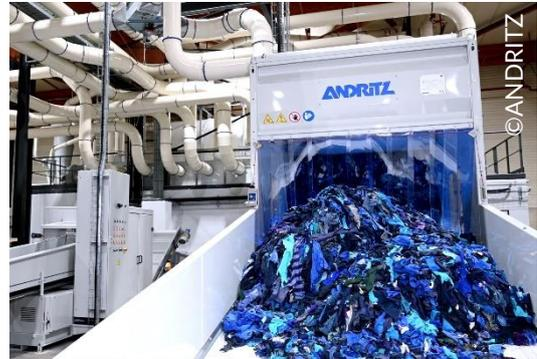
Le **broyage** consiste à réduire la taille des textiles en chiquettes, broyat ou fibres de l'ordre de quelques cm ou mm. La dimension dépendra de l'usage de la matière en sortie.
